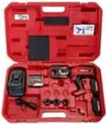
Kit pressatrice assiale con valigia.<br>Fornito in una valigetta di plastica con:<br>2 riduttori Ø 12 mm, 2 riduttori Ø 16 mm, 1 doppio adattatore on battuta scanalata, 1 doppio adattatore con battuta piana. | 01PR08218 | 420,00     |
